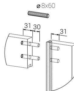
отверстия  $\varnothing 8 \times 31$
