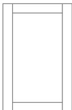
5-ти элементный фасад — изготавливается из TSS плиты толщиной 18 мм, направление рисунка профиля и вставки продольное
