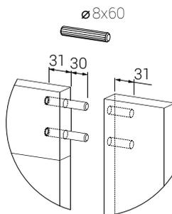
отверстия  $\varnothing 8 \times 31$
