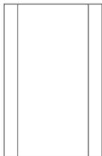
3-х элементный фасад — изготавливается из TSS плиты толщиной 18 мм, направление рисунка профиля продольное, рисунка вставки — поперечное
