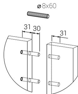
отверстия  $\varnothing 8 \times 31$
