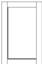
Рамочный фасад — изготавливается из TSS плиты толщиной 18 мм (профиль) и 8мм (вставка), направление рисунка профиля и вставки продольное
