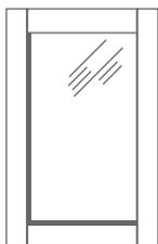
Рамочный фасад со стеклом — изготавливается из TSS плиты толщиной 18 мм (профиль), направление рисунка профиля продольное, вставка из белого матового стекла толщиной 4мм
