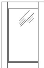
Рамочный со стеклом — изготавливается из TSS плиты толщиной 18 мм (профиль), направление рисунка профиля продольное, вставка из белого матового стекла толщиной 4мм
